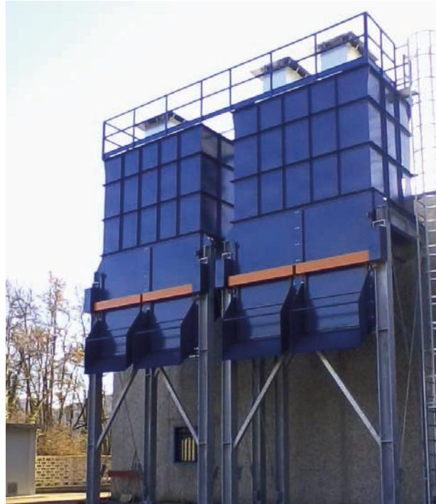
Silos verticali a scarico laterale
