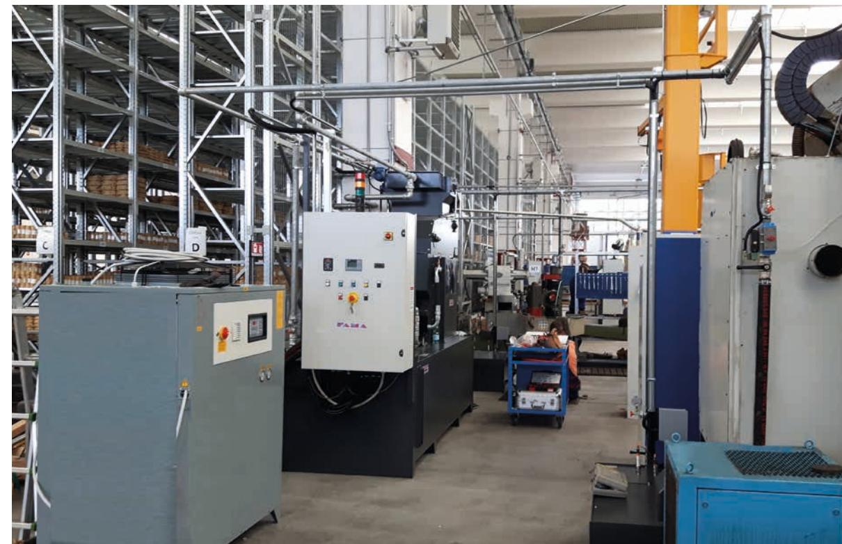
La refrigerazione del lubrorefrigerante è utile per l'ottimizzazione delle lavorazioni e consente di raggiungere e mantenere una maggior precisione sui pezzi lavorati. Garantisce inoltre, nel tempo, una minor usura delle guarnizioni e di tutti gli organi in movimento.
